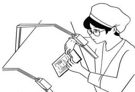
图 B.21 使用放大镜进行 PCB 板维修
